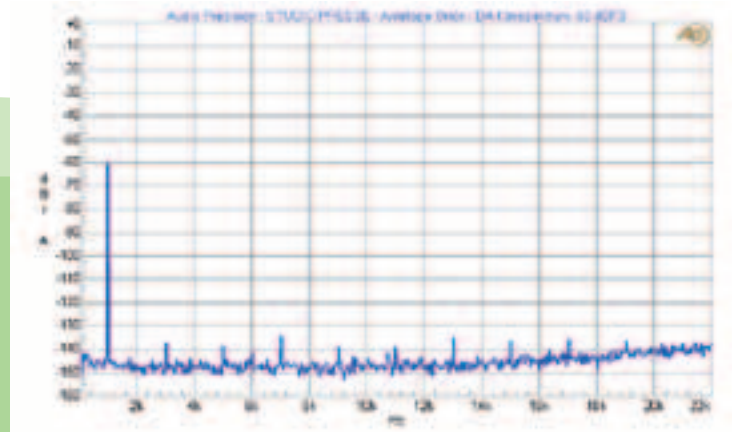
Diagramm 8: Klirrspektrum des D/A-Wandlers bei -60 dBFS
