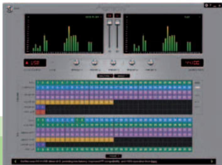
Abbildung 1: Das Routing orientiert sich anhand von Farben. In diesem Beispiel sind die beiden ersten Analogeingänge sowohl auf die Analogausgänge 1 & 2, als auch 9 & 10 geroutet
